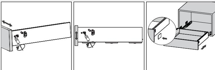
регулировка по ширине ±1,5 мм
