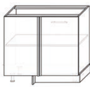
Модуль нижний угловой с присадкой под 1 дверь, 1 полка ЛДСП
