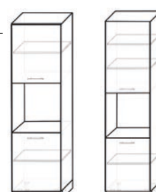
Модуль для бытовой техники с присадкой под 2 фасада, 2 или 3 полки ЛДСП
