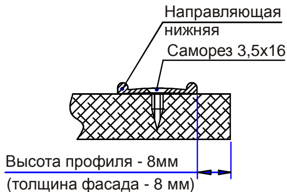
Рис.7 Установка нижней направляющей
